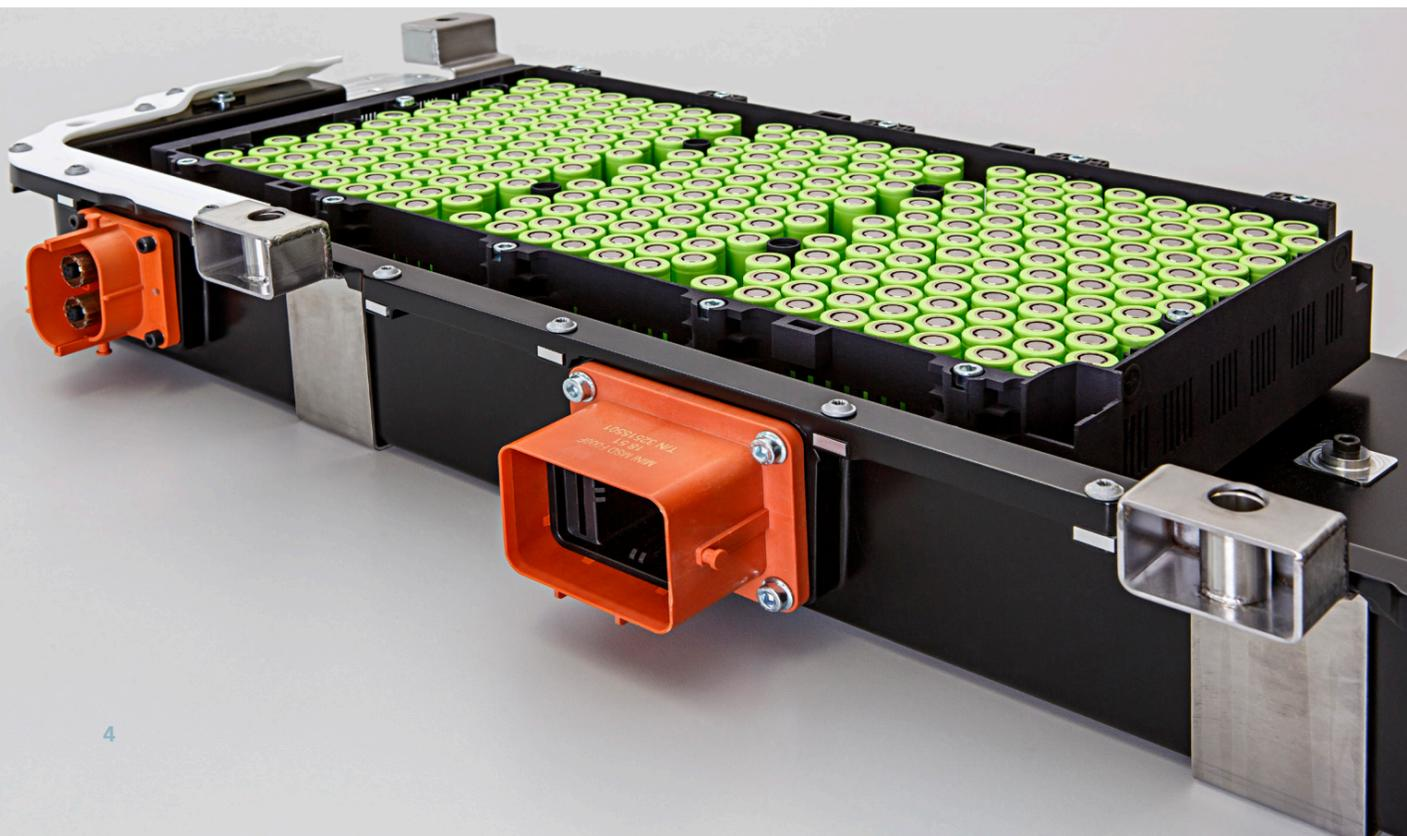
2nd-Life Anwendung ist durch den Cell to Pack Aufbau nur sehr schwer möglich, denn die Zellen lassen sich nur durch sehr hohen Aufwand zerstörungsfrei voneinander separieren oder austauschen.
