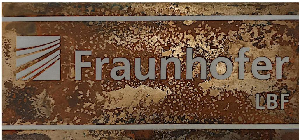
**Die neue Salzpaste wirkt zuverlässig und exakt. Sie kann für unterschiedliche Anwendungen individuell angepasst werden und minimiert die umweltrelevanten Auswirkungen von Korrosionsprüfungen. Foto: Fraunhofer LBF**
