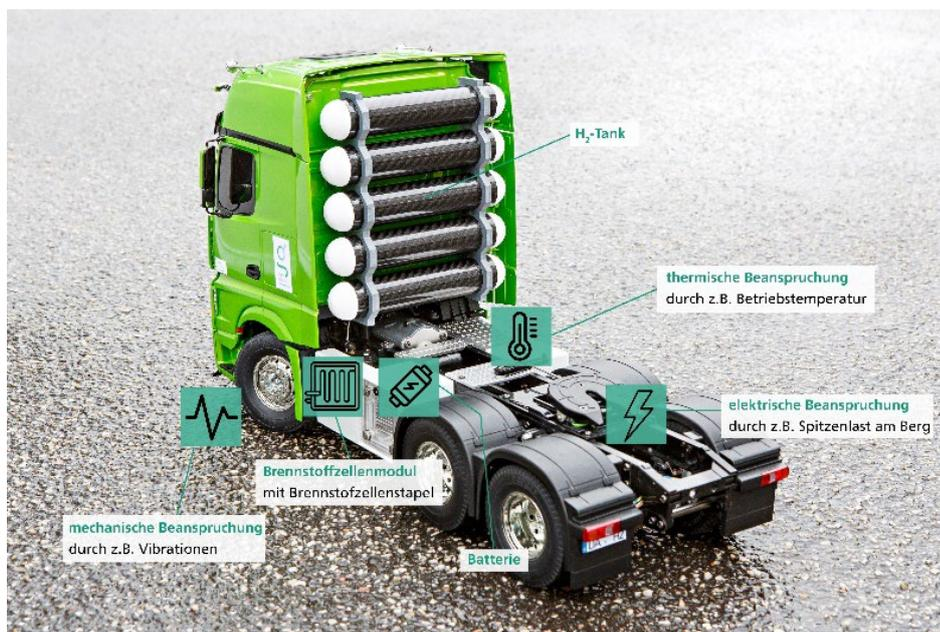
Fraunhofer-Forschende bewerten in »multiPEM« die Systemzuverlässigkeit von Brennstoffzellen-Stapeln unter multiphysikalisch-chemischer Beanspruchung in Nutzfahrzeugen.
