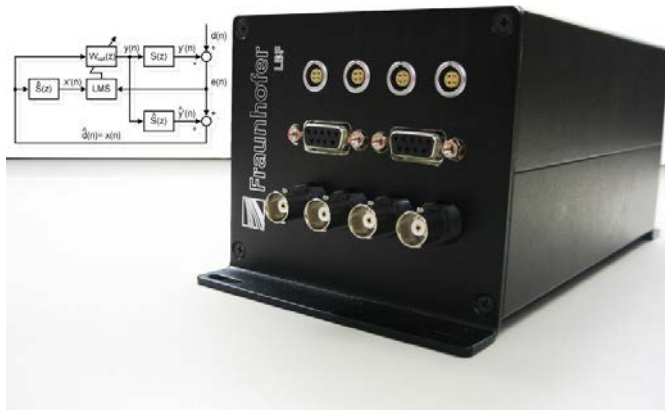
Signalverarbeitungsplattform mit industriellem 32-bit Mikrocontroller. Foto: Fraunhofer LBF
