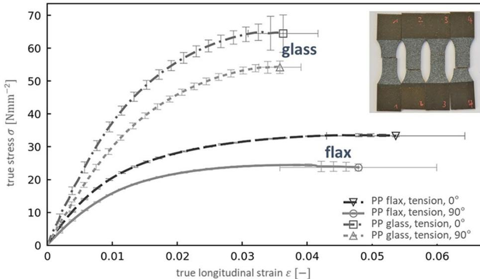
Ergebnisse aus Zugversuchen an kurzfaserverstärktem, spritzgegossenem Polypropylen. Verglichen werden Probekörper mit Flachs bzw. mit Glas-Fasern, die jeweils in zwei Orientierungen 0° und 90° aus Platten entnommen wurden. Grafik: Fraunhofer LBF
