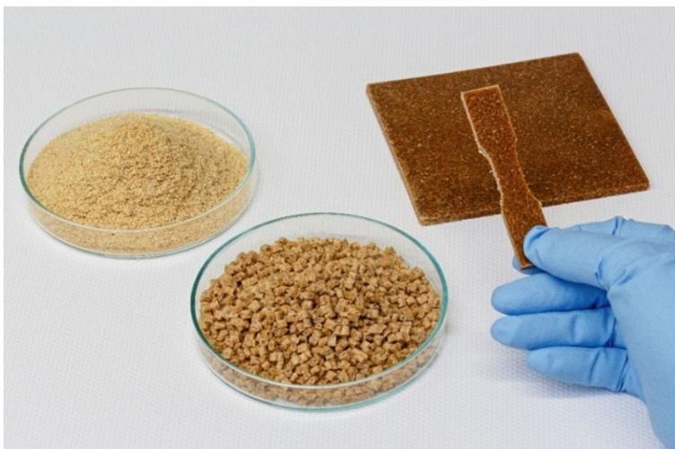
**Naturfaserverstärkten Kunststoffe bieten auch für technische Bauteile hohes Anwendungspotenzial. Foto: Fraunhofer LBF, Ursula Raapke**
