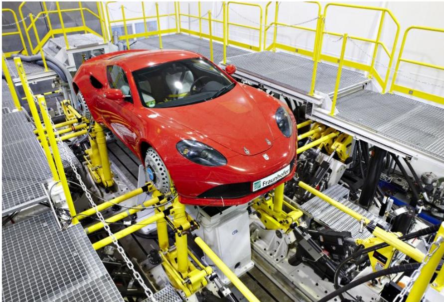
Fraunhofer-Konzeptfahrzeug Frecco 2.0 auf dem Ganzfahrzeugprüfstand in Darmstadt.
