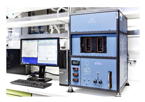
Materialeigenschaften können mit Hilfe von Sorptionsmessungen bestimmt werden. Diese und Ergebnisse aus weiteren Analysen verwenden die Forschenden als Grundlage für Modell-Erstellungen und Simulationen.
