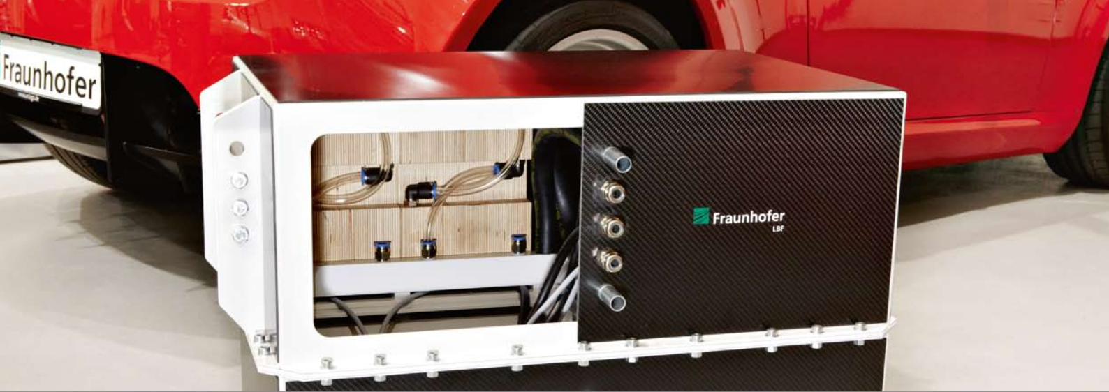
Batterieschutzgehäuse vor dem Fraunhofer Konzeptfahrzeug Frecc0. Battery housing in front of the Fraunhofer e-concept car Frecc0.
