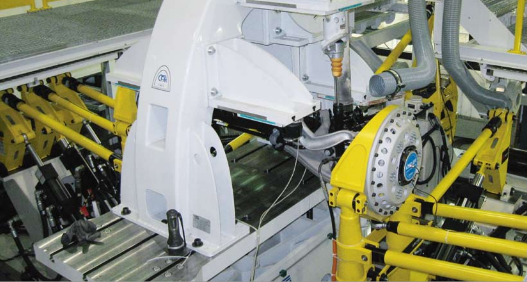
Prüfstand im Modus Achserprobung: Segment mit Hubtisch und Achsbock. Test stand in the axis test mode: segment with lift table and axle support.
