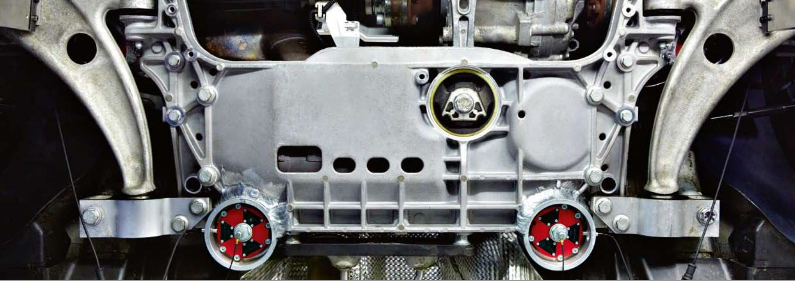
Die Fahrverkaufhängung im Versuchsfahrzeug mit den roten aktiven Lagern. Carriage suspension in test vehicle with the red active mounts.
