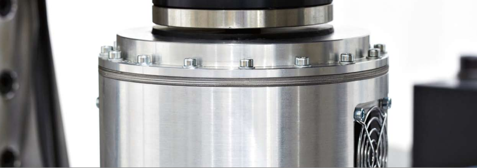
Aktives Lager zur Entkopplung des Motors von der Karosserie. Active engine mount for decoupling the motor from the body work.
